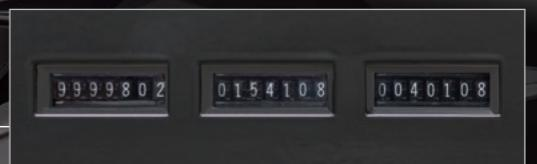
ノズル毎のトータル積算量を、パネルを開けずに一目で確認可能。日常管理の簡素化につながります。
